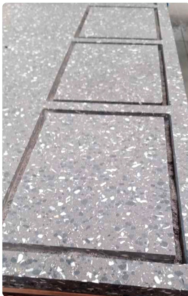
Fresatura CNC del pannello di Tipo 2 rivestito CNC milling of coated Type 2 panel
