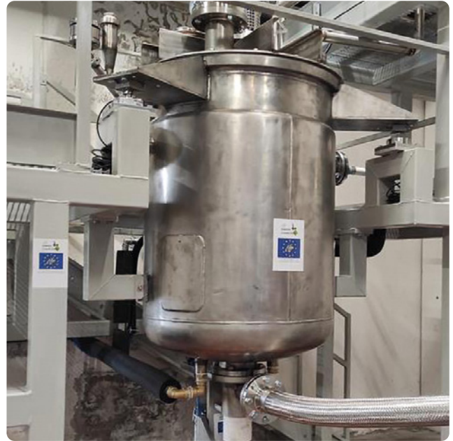
Reattore per la pre-polimerizzazione del r-MMA Reactor for r-MMA pre-polymerization
